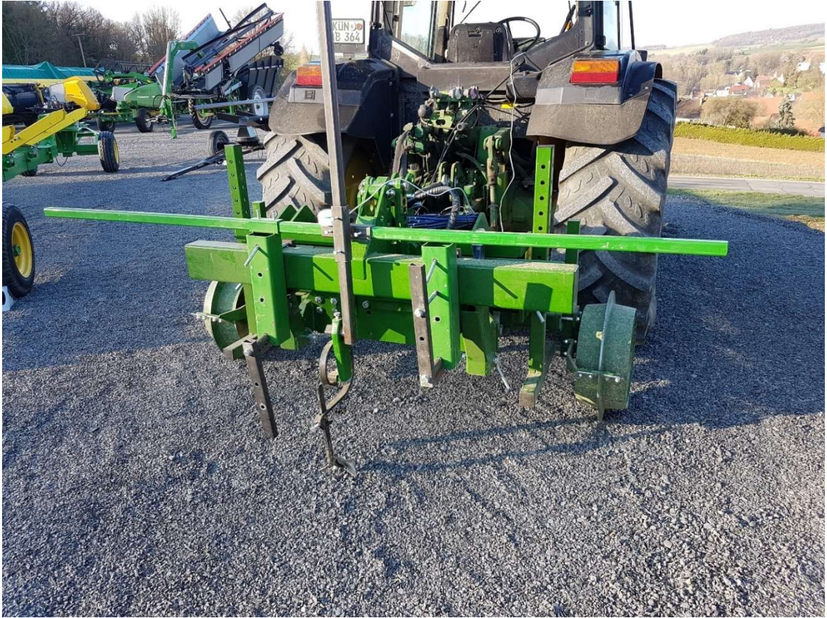
Abbildung 7: Versuchsträger mit aufgebautem GPS System
